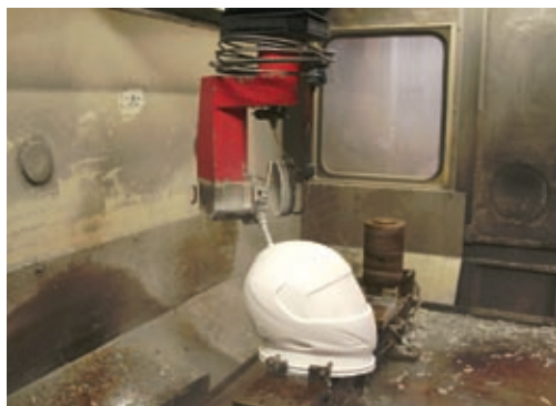
5 - Robot antropomorfo che esegue il taglio con idrogetto
