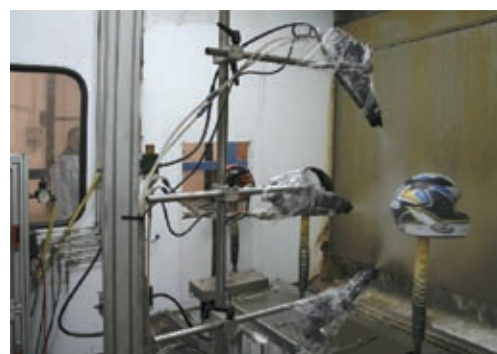
9 - Qui sotto, applicazione della mano finale trasparente UV.
